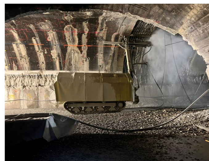
5A e 5B. Il TrackJet 2.0 al lavoro in galleria. Interamente elettrico, ha un'autonomia di movimentazione di 4 km
