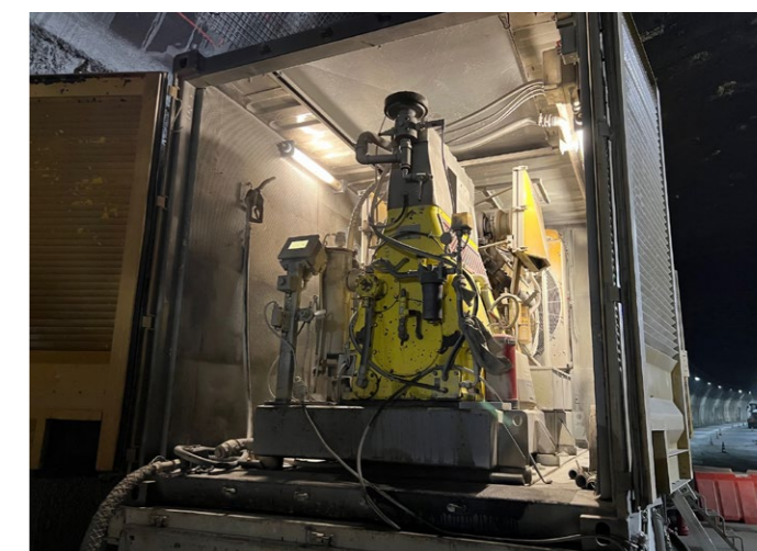
3. Una motopompa ad altissima pressione: può raggiungere i 2.500 bar per getti da 300 litri di acqua al minuto
